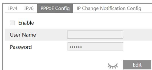
Qualquer método de conexão de rede pode ser usado. Se o PPPoE for usado para conectar a internet, a câmera receberá um endereço IP WAN dinâmico. Este endereço IP mudará com frequência. Para ser notificado, a função de notificação de alteração de IP pode ser usada.
