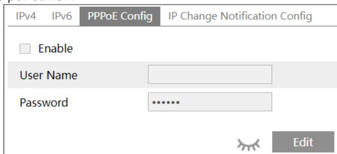
Cualquiera de los dos métodos de conexión de red puede ser utilizado. Si se usa PPPoE para conectarse a internet, la cámara obtendrá una dirección IP WAN dinámica, que cambiará frecuentemente. Para ser notificado de estos cambios, puede utilizar la función de notificación de cambio de IP.
