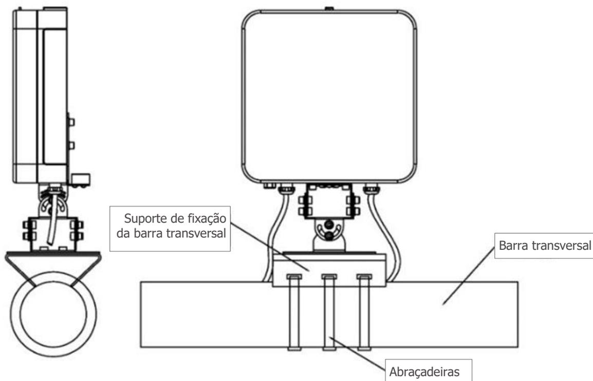
Figura 4 – Fixação do Radar com abraçadeira
