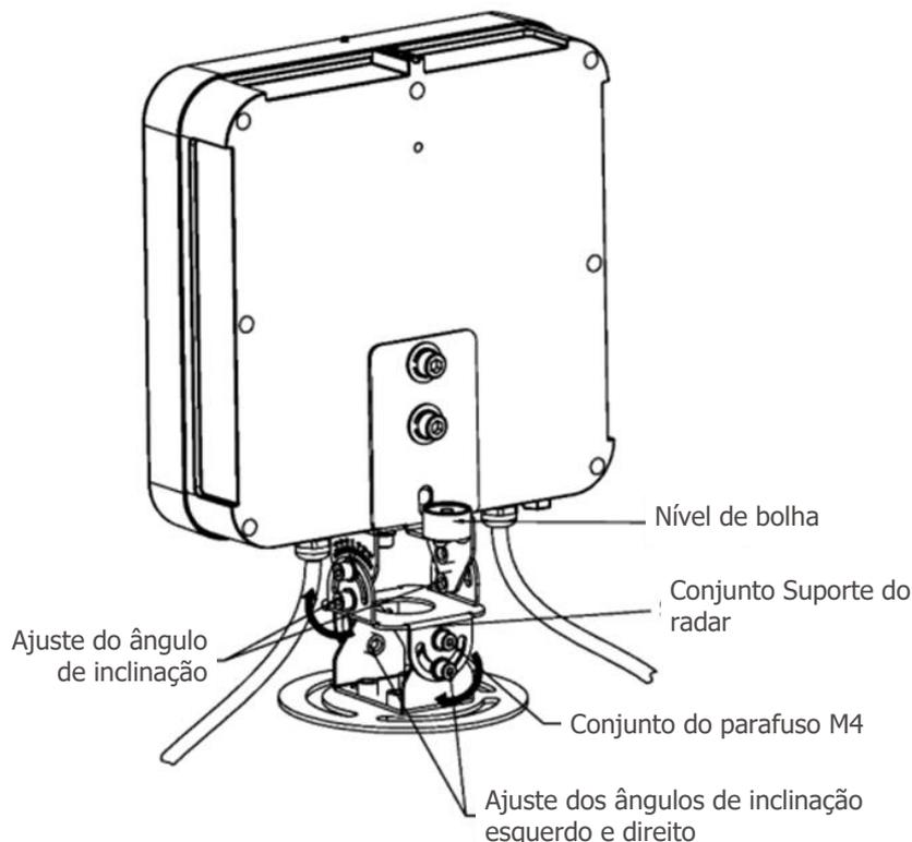
Figura 2 – Radar ITSDETECTOR 24L-3 e Conjunto Suporte
