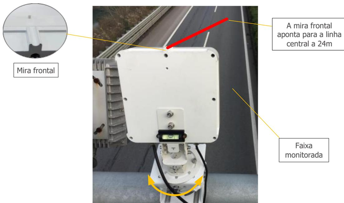
Figura 10 – Diagrama de rotação horizontal
