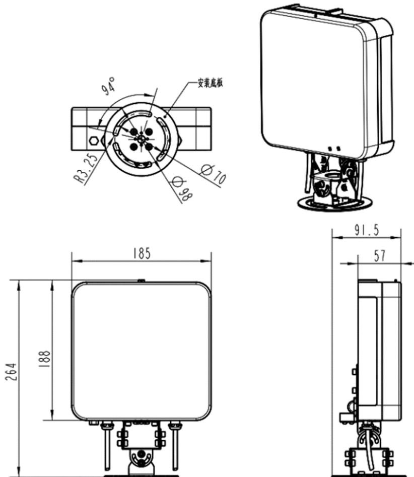
Figura 3 – Dimensões do radar ITSDETECTOR 24L-3
