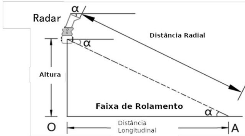
Figura 6 – Diagrama esquemático do radar no ajuste do ângulo de inclinação
