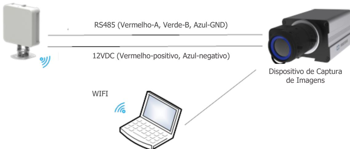
Figura 12 – Diagrama Esquemático de Conexão do Radar
