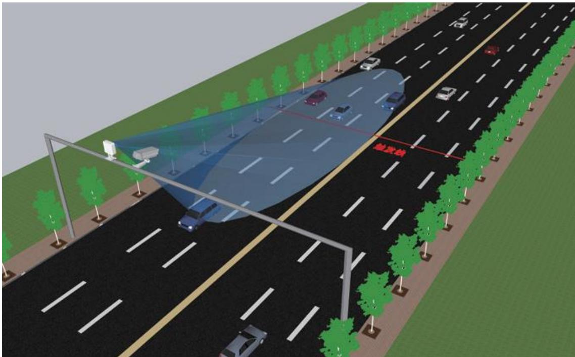
Figura 5 – Ejemplo de instalación del modelo ITSDETECTOR 24L-3 (HT-MTTR-3-485-C2)
