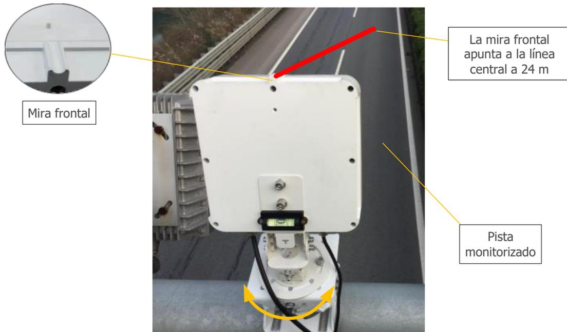
Figura 10 – Diagrama de rotación horizontal
