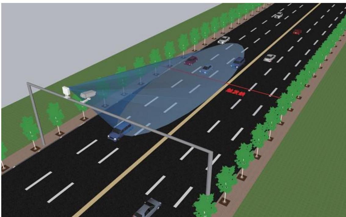
Figura 5 – Exemplo de instalação do modelo ITSDETECTOR 24L-3 (HT-MTTR-3-485-C2)
