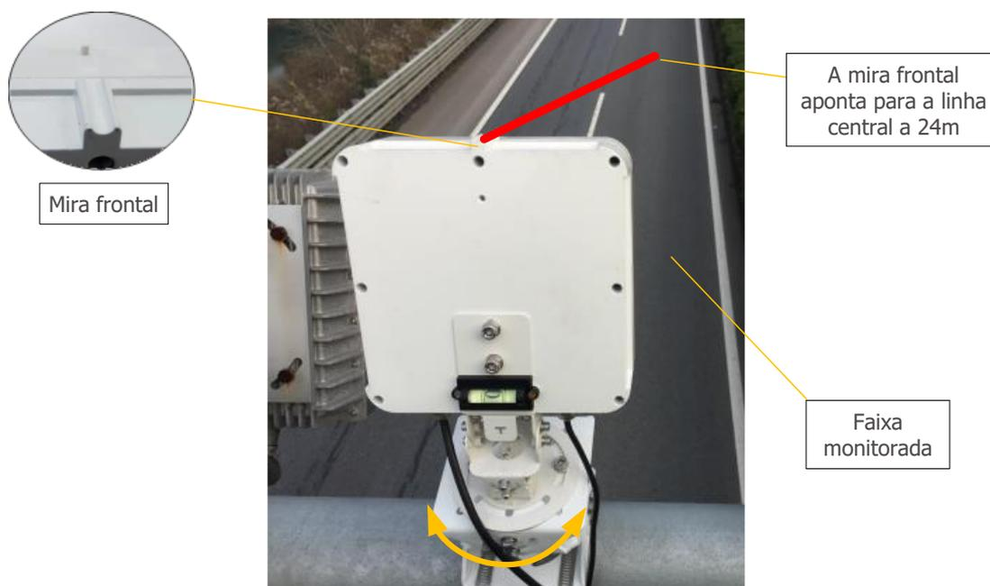
Figura 10 – Diagrama de rotação horizontal
