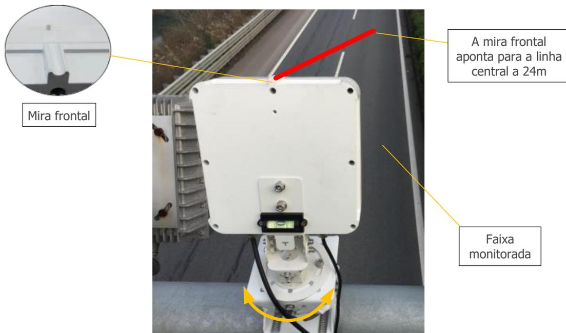
Figura 10 – Diagrama de rotação horizontal
