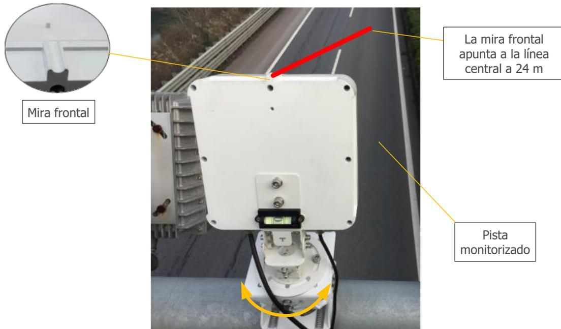
Figura 10 – Diagrama de rotación horizontal
