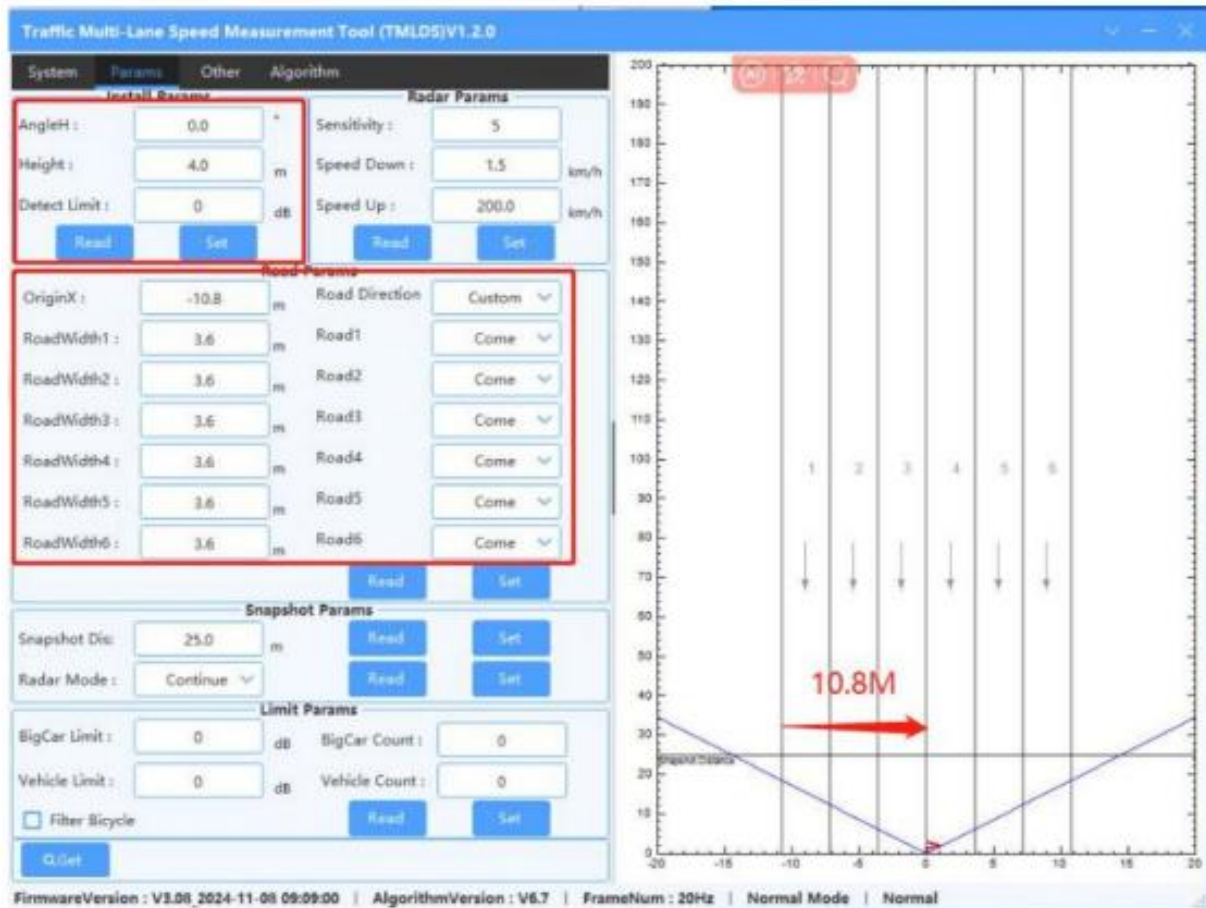
Figura 9 - Ajustes de parámetros para el modo de aproximación continua de 0 grados
