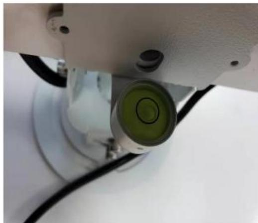
Figura 3 - Diagrama Esquemático del Ajuste Horizontal
