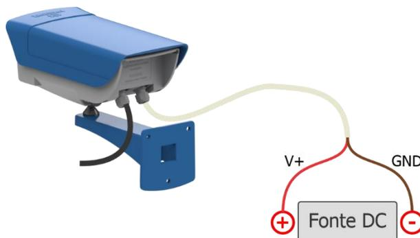
Figura 19 - Conexão de alimentação e sinais da ITSCAM 450+
