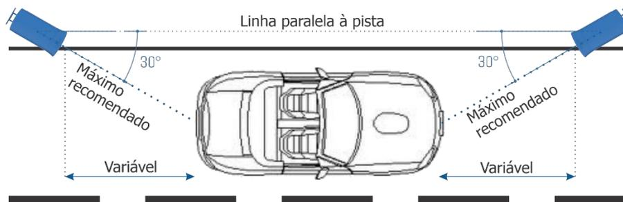
Figura 18 - Vista Superior da instalação
