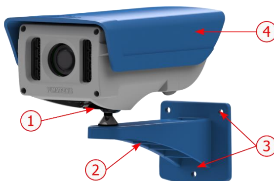
Figura 4 - Fijación del Soporte 450+: 1) Ajuste de inclinación del dispositivo 450+; 2) Soporte 450+; 3) puntos de fijación, utilizando tornillos 3/16"; 4) pestaña deslizante, ajustada en el encuadre
