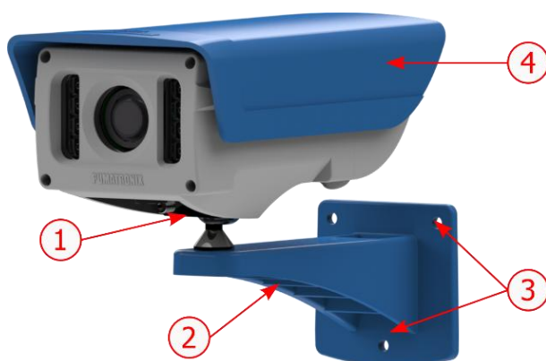
Figura 4 - Fixação do Suporte 450+: 1) Ajuste de inclinação do dispositivo; 2) Suporte 450+; 3) Pontos de fixação, utilizando parafusos 3/16"; 4) Aba deslizante, ajustada no enquadramento
