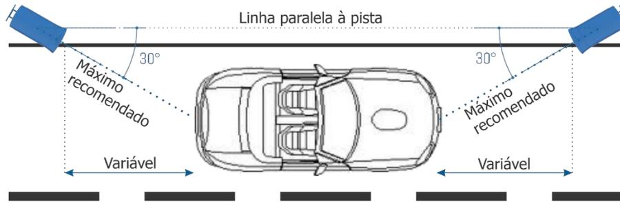
Figura 19 - Vista superior de la instalación
