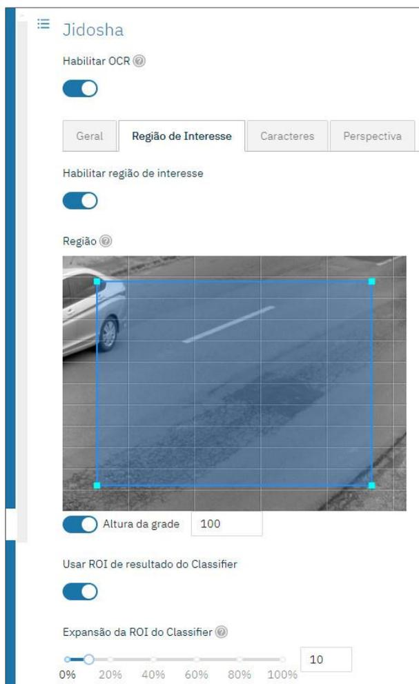
Figura 16 – Interfaz web del ITSCAM 450+ para la configuración de Región de Interés de OCR
