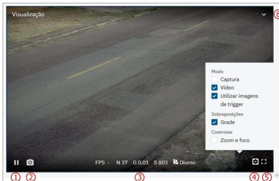
*Figura 9 – Janela flutuante de visualização ao vivo: 1) Pausar visualização ao vivo; 2) Tirar foto; 3) Valores de FPS, Nível, Ganho, Shutter e Perfil de Imagem ativos; 4) Configurações de visualização; 5) Tela inteira; 6) Minimizar janela*
