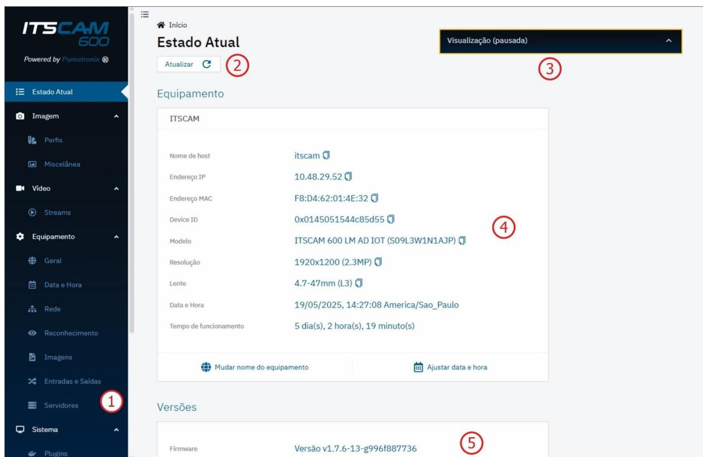
Figura 6 - Opções disponíveis na interface e na janela do Estado Atual: 1) Barra de menus; 2) Botão de ação disponível para a funcionalidade; 3) Janela flutuante de visualização ao vivo; 4) Dados do Equipamento, incluindo o Tempo de funcionamento detalhado e botões de ajuste rápido, 5) Dados das versões de firmware instaladas
