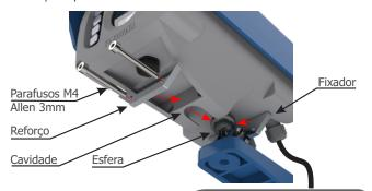
**22**. Prenda a ITSCAM 450+ no *Suporte 450*+, apertando os parafusos. Sugestão: utilize uma chave com comprimento superior a 10cm em formato
