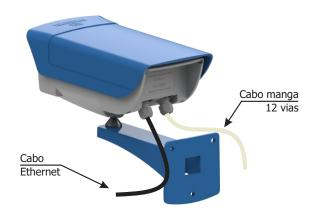
Risco de Oxidação: As conexões elétricas e de sinal realizadas no chicote da ITSCAM 450+ e no cabo de rede de dados devem ser protegidas em caixa de passagem ou estrutura semelhante para evitar a oxidação das ligações e infiltração indesejada de líquidos no chicote.
