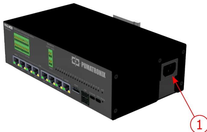
Figura 9 - Conector de alimentação e sinais (cabo manga 6 vias)
