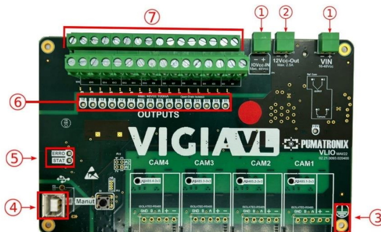
Figura 6 - Interfaces da Placa VLIO: 1) Entradas de Alimentação; 2) Conexão de saída para alimentação da Firefly (ULP); 3) Aterramento da placa (deve ser ligado ao GND da Instalação); 4) Conexão de dados USB; 5) LED ERRO e LED STAT; 6) LEDs indicativos dos sinais de Saída; 7) Saídas dos sinais para o Controlador Semafórico
