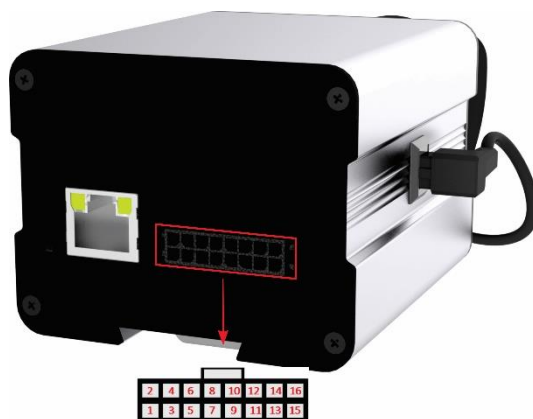
Figura 10 – Terminales del conector de alimentación y señal (Microfit) ITSCAM 450
