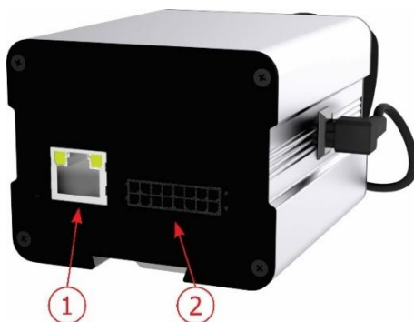
Figura 7 - Interfaces disponíveis no dispositivo: 1) Ethernet; 2) Microfit 16 vias (conector alimentação, IOs, RS-232)
