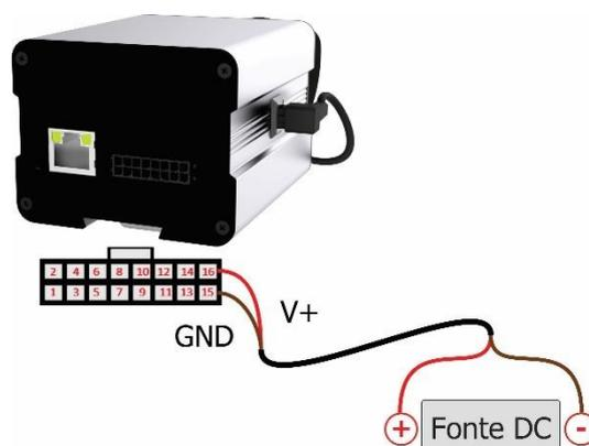
Figura 20 - Conector de alimentação e sinais (Microfit) da ITSCAM 450
