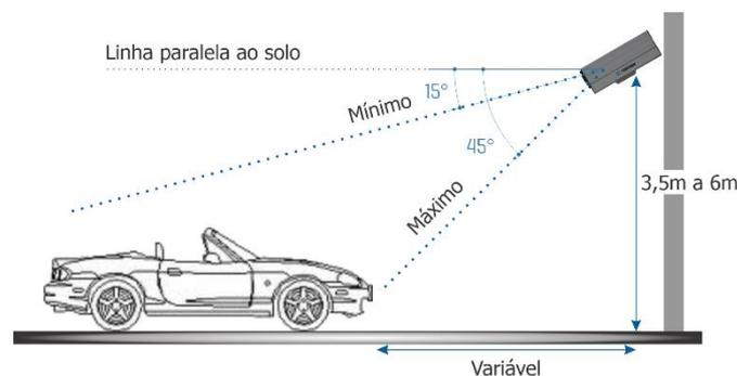
Figura 18 - Vista Lateral da instalação
