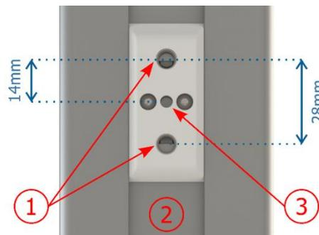
Figura 5 - Especificações do Mecanismo de Fixação: 1) Rosca para parafusos ¼"; 2) Trilho para alteração do ponto de fixação; 3) Orifício Ø4 mm para pino guia
