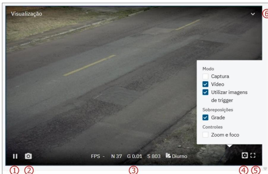
*Figura 9 – Ventana flotante de visualización en directo: 1) Pausar la visualización en directo; 2) Tomar fotos; 3) Valores de FPS, Nivel Activo, Ganancia, Obturador y Perfil de Imagen; 4) Configuración de visualización; 5) Pantalla completa; 6) Minimizar ventana*
