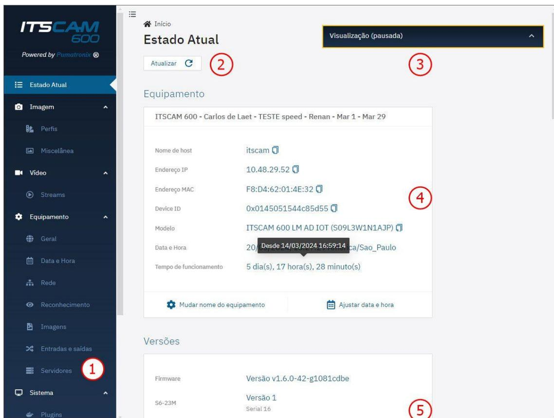
Figura 6 - Opciones disponibles en la interfaz y en la ventana Estado actual: 1) Barra de menú; 2) Botón de acción disponible para la funcionalidad; 3) Ventana flotante de vista en vivo; 4) Datos del equipo, incluidos el tiempo de ejecución detallado y los botones de ajuste rápido, 5) Datos de las versiones de firmware instaladas
