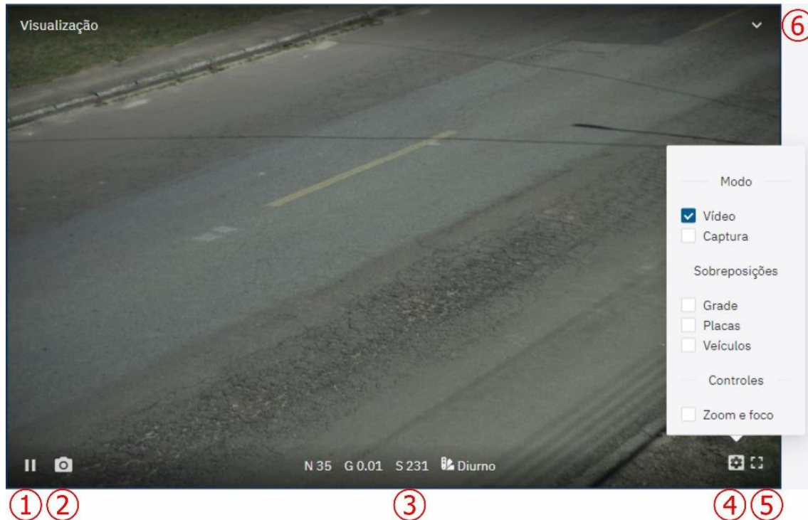
Figura 18 – Janela flutuante de visualização ao vivo: 1) Pausar visualização ao vivo; 2) Tirar foto; 3) Valores de Nível, Ganho, Shutter e Perfil de Imagem ativos; 4) Configurações de visualização; 5) Tela inteira; 6) Minimizar janela
