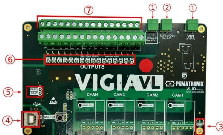
Figura 7 - Interfaces de la placa VLIO: 1) Entradas de alimentación; 2) Conexión de salida para la alimentación de Firefly (ULP); 3) Conexión a tierra de la placa (debe conectarse a la GND de la Instalación); 4) Conexión de datos USB; 5) LEDs de ERROR y STAT; 6) LEDs indicadores de las señales de salida; 7) Salidas de señales hacia el Controlador de Tráfico.
