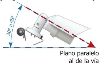
**Paso 14:** Fije la posición del VL-SENSOR-D atornillando los tornillos.
