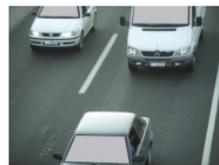
30. Utilice la función de enfoque automático cuando el modelo ITSCAM 450 tenga lentes motorizadas o ajuste de zoom y enfoque accediendo al menú Imagen > Perfiles en la pestaña Lentes, hasta que los caracteres se aclaren en la imagen vista.
