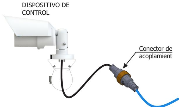
**Paso 6:** Coloque el conector de acoplamiento ensamblado con el cable Ethernet en el soporte de poste.
