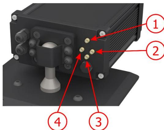
Figura 9 – Pontos de conexão das antenas\* na VTR 600
