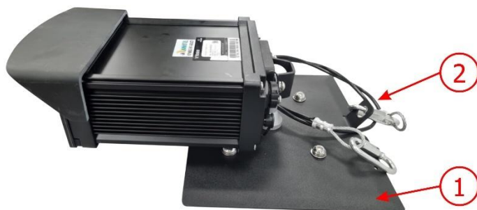
Figura 3 – Fixação da VTR 600: 1) imãs da base, 2) cabo de aço de segurança
