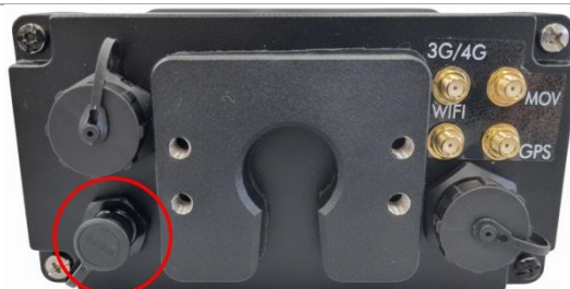
Figura 5 – Conector de alimentação e sinais da VTR 600 (cabo manga 2 vias)
