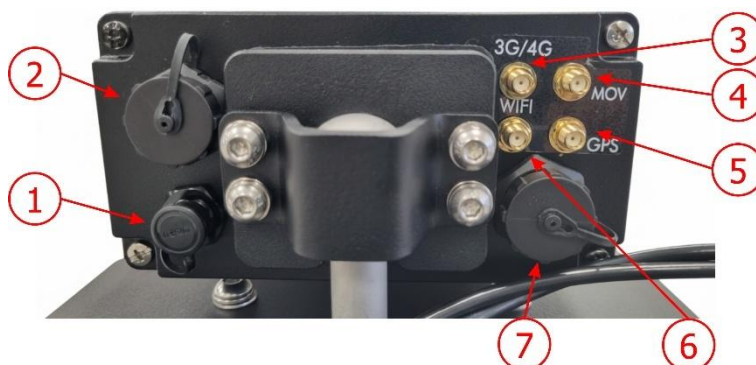
Figura 4 - Interfaces disponíveis na VTR 600
