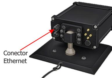
2. Utilize cabo com conector RJ-45 seguindo a pinagem do padrão TIA-568A:
