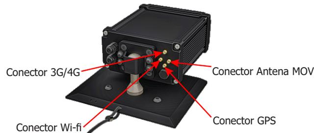
5. Conecte as antenas disponíveis aos conectores SMA respectivos 3G/4G, Wi-fi, GPS e Antena MOV.
