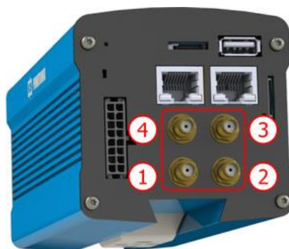
Figura 14 - Conectores SMA para as antenas (podendo haver variações dependendo do modelo*)
