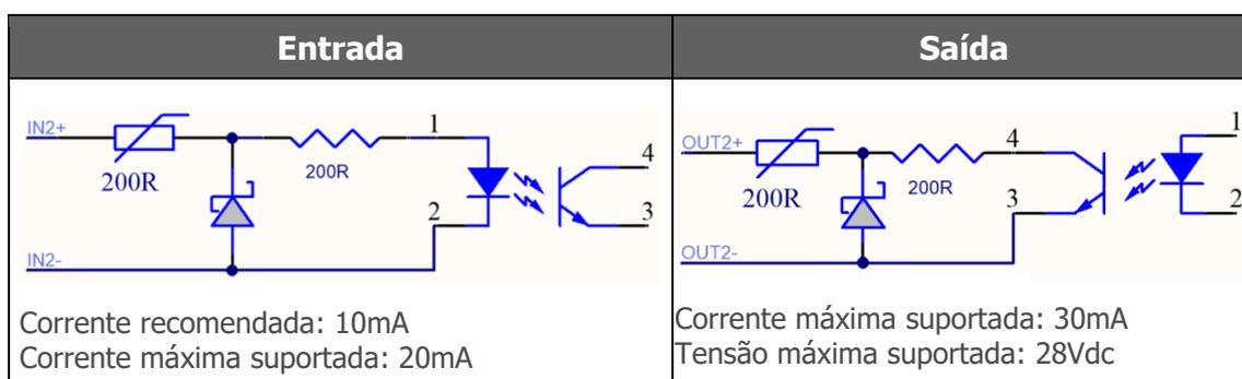
Figura 35 - Circuito dos sinais de entrada/ saída isoladas da ITSCAM 400
