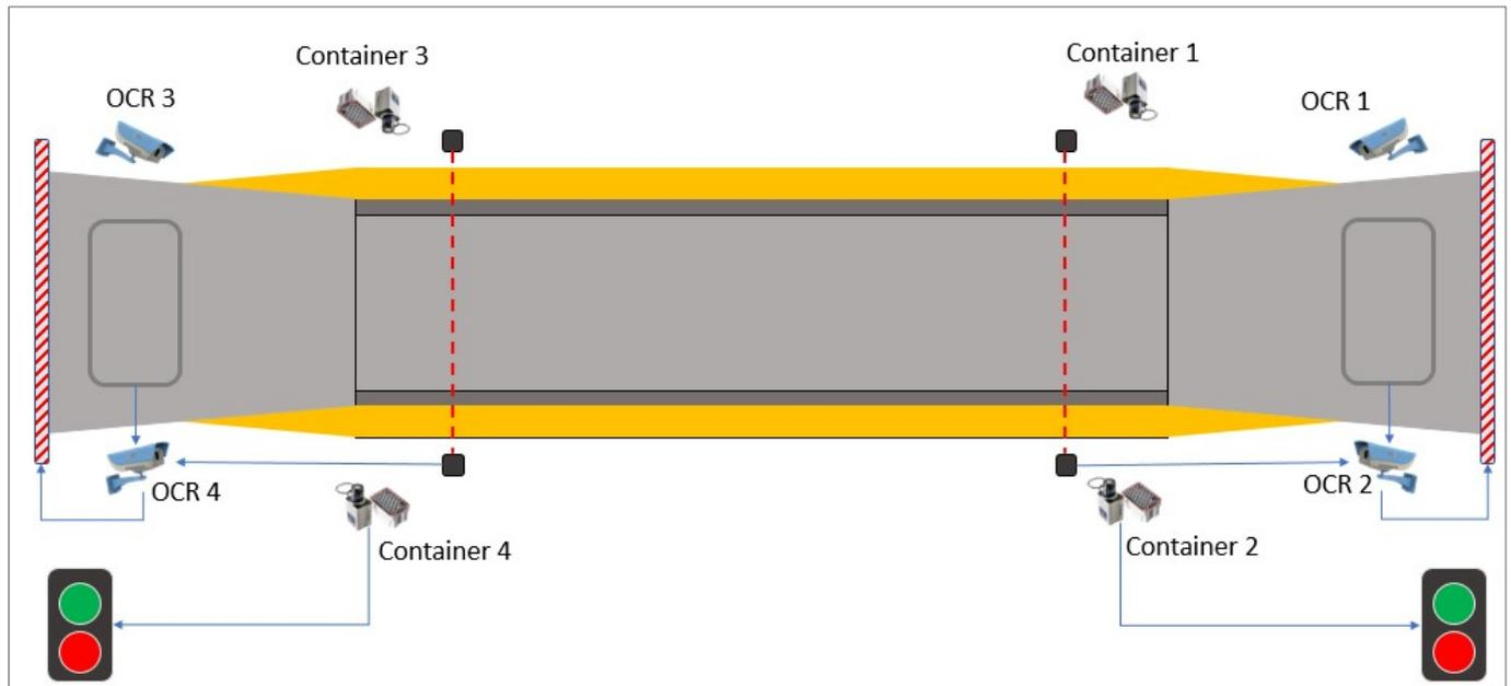
Figura 13 – Diagrama da Arquitetura do Sistema WeGate
