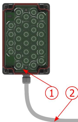
Figura 11 - Interfaz del ITSLUX: 1) LED indicativo del funcionamiento; 2) Cable tipo manga de 6 vías
