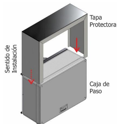
Figura 15 - Instalación de la Tapa Protectora en la Caja de Paso
