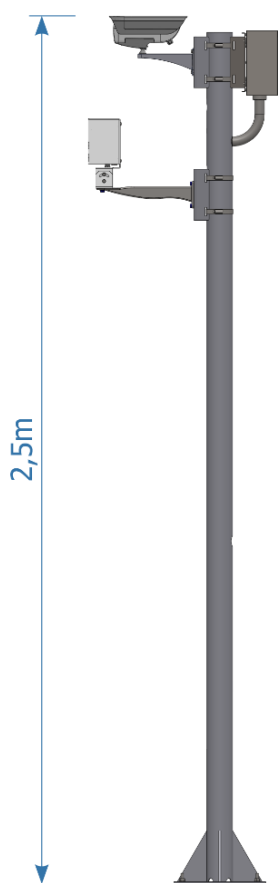
Figura 16 - Poste Panorámico con ITSCAM VIGIA+, ITSLUX (opcional) y Caja de Paso fijados
