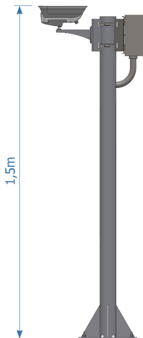
Figura 13 - Poste Traseiro com ITSCAM VIGIA+ e Caixa de Passagem fixados
