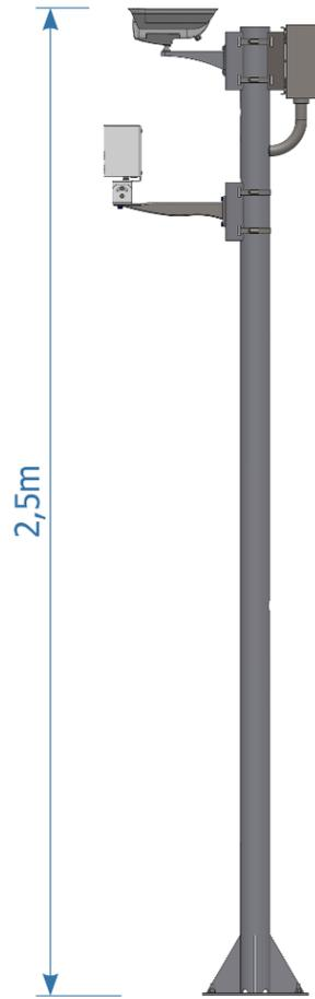
*Figura 11 - Poste Panorámico con ITSCAM VIGIA+, ITSLUX (opcional) Y Caja de Pasaje fijados*
