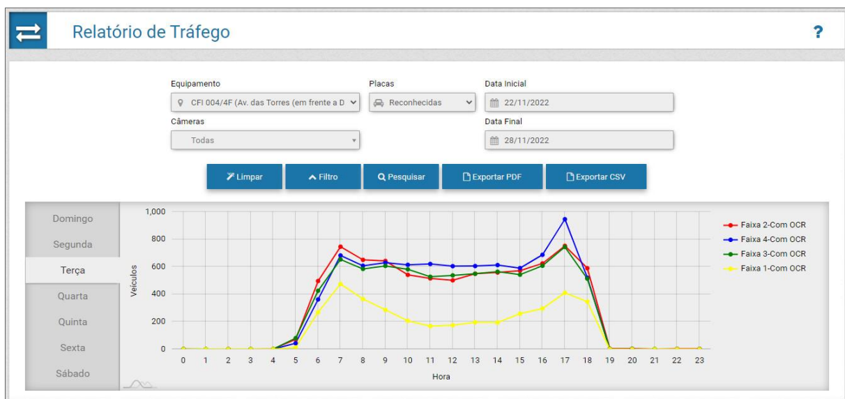
Figura 30 - Exemplo de Relatório de Tráfego gerado para equipamento com 4 dispositivos de captura
