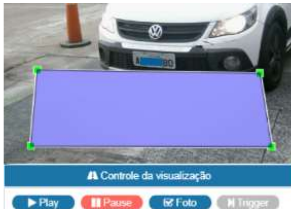
Figura 44 – Tela da Interface Web da ITSCAM com uma região de interesse (ROI) configurada. O algoritmo de OCR busca por placas na parte interna do retângulo
