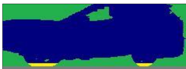
Figura 45 - Perfil Magnético que permite identificar um carro
