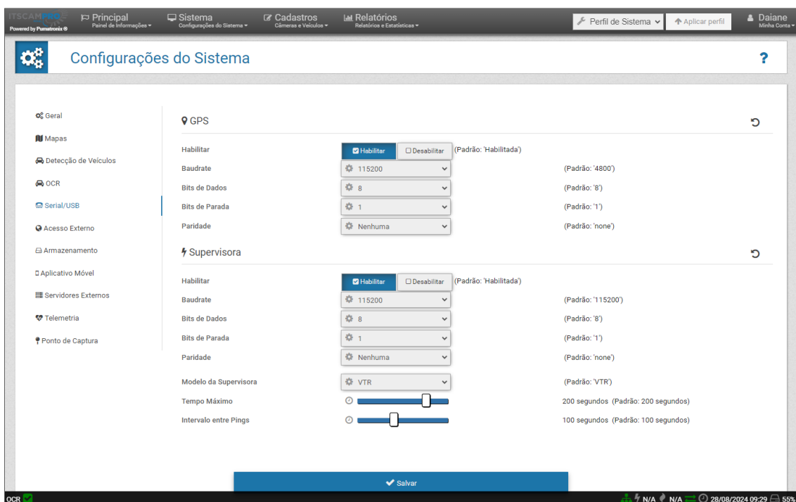
Figura 27 - Tela de configuração do GPS e placa Supervisora
