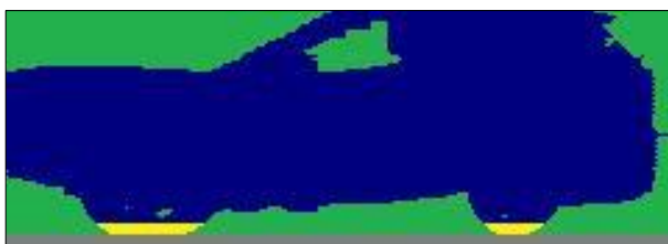
Figura 45 - Perfil Magnético que permite identificar um carro
