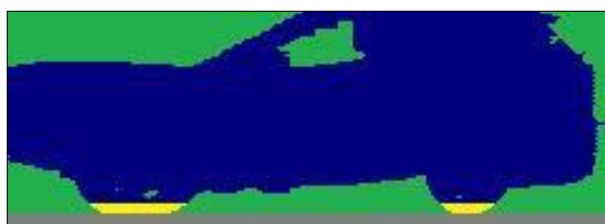
Figura 45 - Perfil magnético que permite identificar un coche
