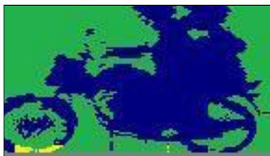
Figura 46 - Perfil Magnético que permite identificar uma motocicleta
