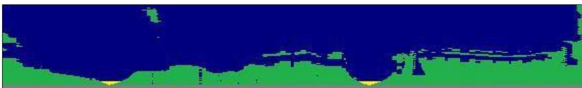
Figura 47 - Perfil Magnético que permite identificar um caminhão
