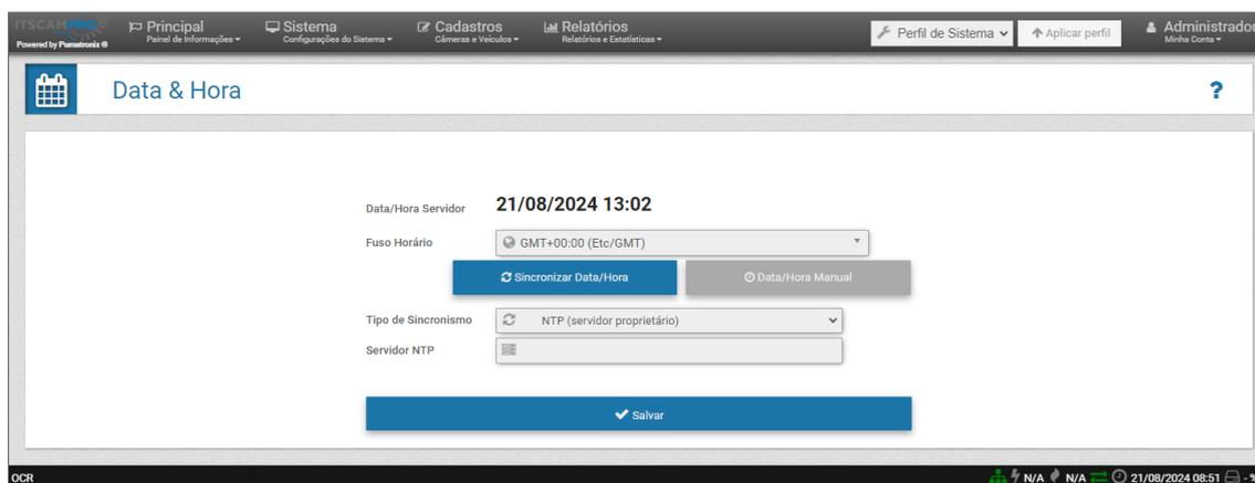
Figura 50 - Pantalla de configuración de fecha/hora con servidor NTP propietario
