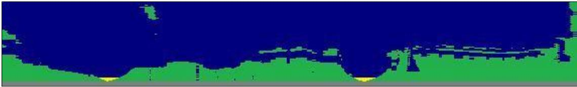
Figura 47 - Perfil magnético que permite identificar un camión
