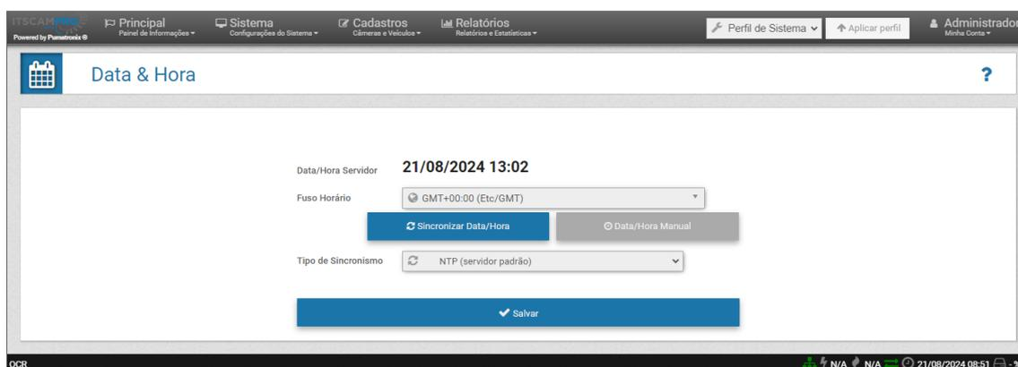
Figura 49 - Pantalla de configuración de fecha/hora con servidor NTP estándar
