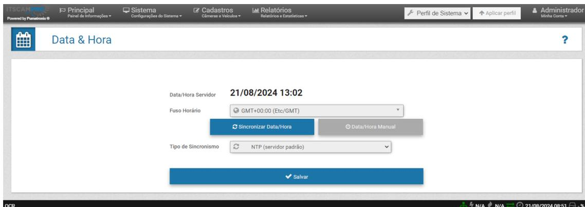
Figura 49 - Tela de configuração de Data/Hora com servidor NTP padrão
