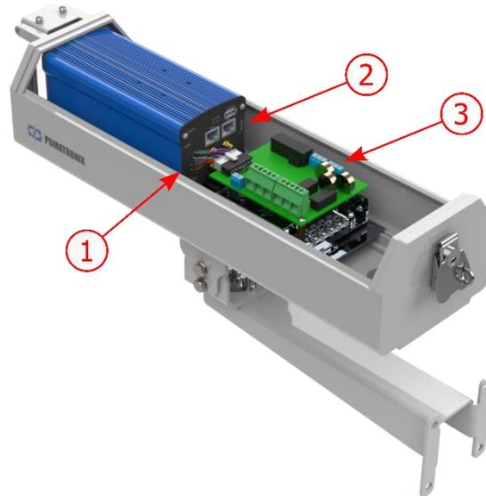
Figura 10 - Conexiones disponibles en el dispositivo ITSCAM FF 600\*: 1) Microfit; 2) Conectores macho Ethernet, SMA para antenas, USB, tarjeta SD y tarjeta SIM; 3) Conectores de la placa de conexión
