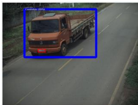
Figura 5 - Classifier identifica un camión
