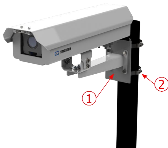
Figura 8 - Fixação em poste: 1) Suporte para Poste; 2) Abraçadeira em inox
