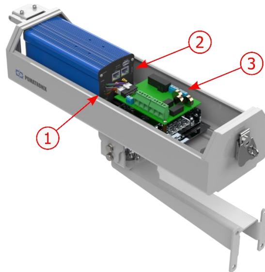
Figura 10 - Conexiones disponibles en el dispositivo ITSCAM FF 600\*: 1) Microfit; 2) Ethernet, conectores SMA macho para antenas, USB, Tarjeta SD y Tarjeta SIM; 3) Conectores de la placa de conexión
