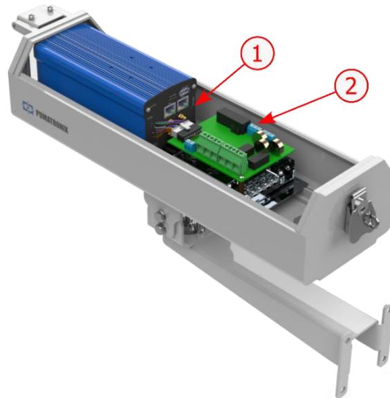
Figura 11 - Interfaces de conexión disponibles: 1) Conectores del dispositivo ITSCAM 600; 2) Conectores de la Tarjeta de Conexión
