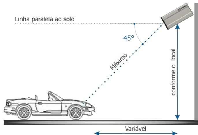
Figura 23 - Vista Lateral da instalação
