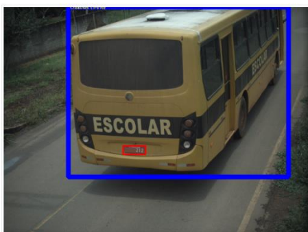
Figura 9 - CLASSIFIER identifica um ônibus
